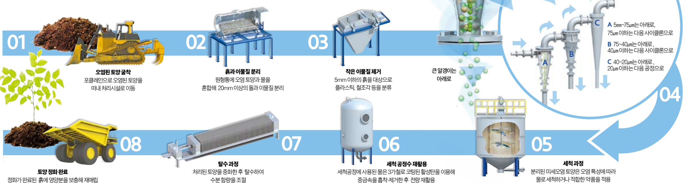
그림2 다단계 사이클론을 이용한 선택적 토양입자분리기법과 3가철(Fe3+)개질활성탄을 활용한 무방류형 세척기법으로 구성된 비소오염 토양정화기술(환경신기술 제415호)
